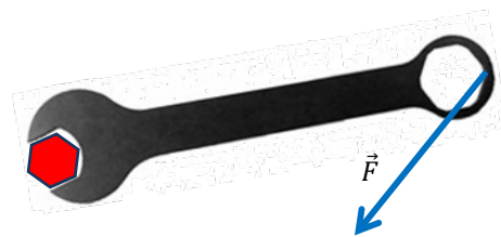
Figuur 14 Een kracht uitgeoefend op een steeksleutel
